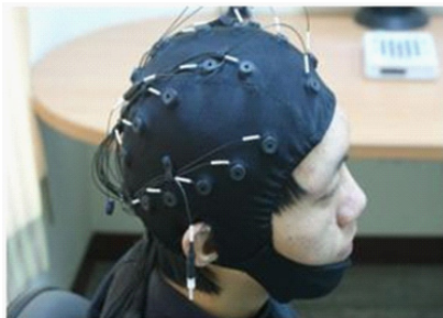
利用腦電波 (EEG) 電極帽進行 3D 影片的疲勞度偵測
